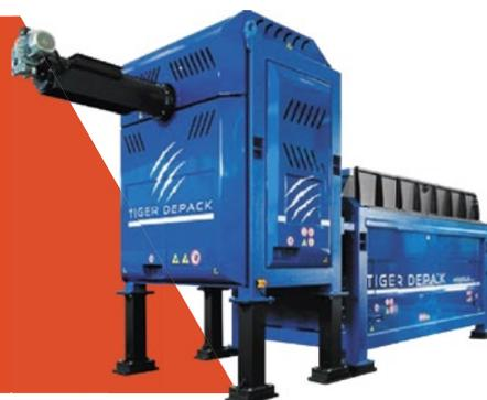
Принцип работы TIGER построен на использовании шнека, отжимающего влагу из массы отходов. «Сухая» фракция промывается водой и выводится с помощью шнека.
